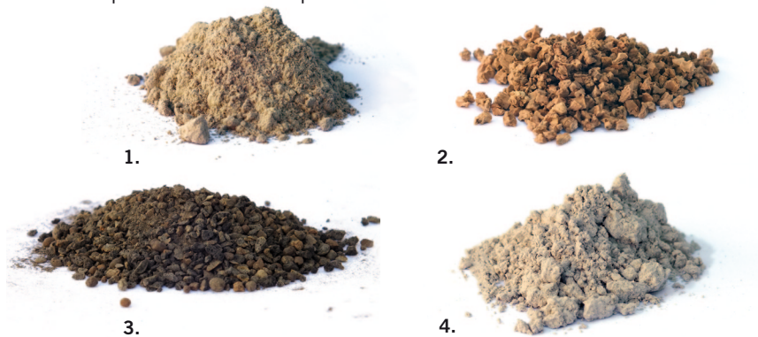
1. Poudre de diatomées / 2. Liège / 3. Argile / 4. Chaux hydraulique
